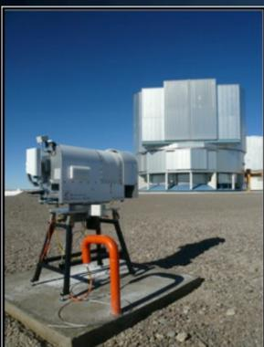
Fig. 1. 183 GHz L-HATPRO radiometer on Paranal.
