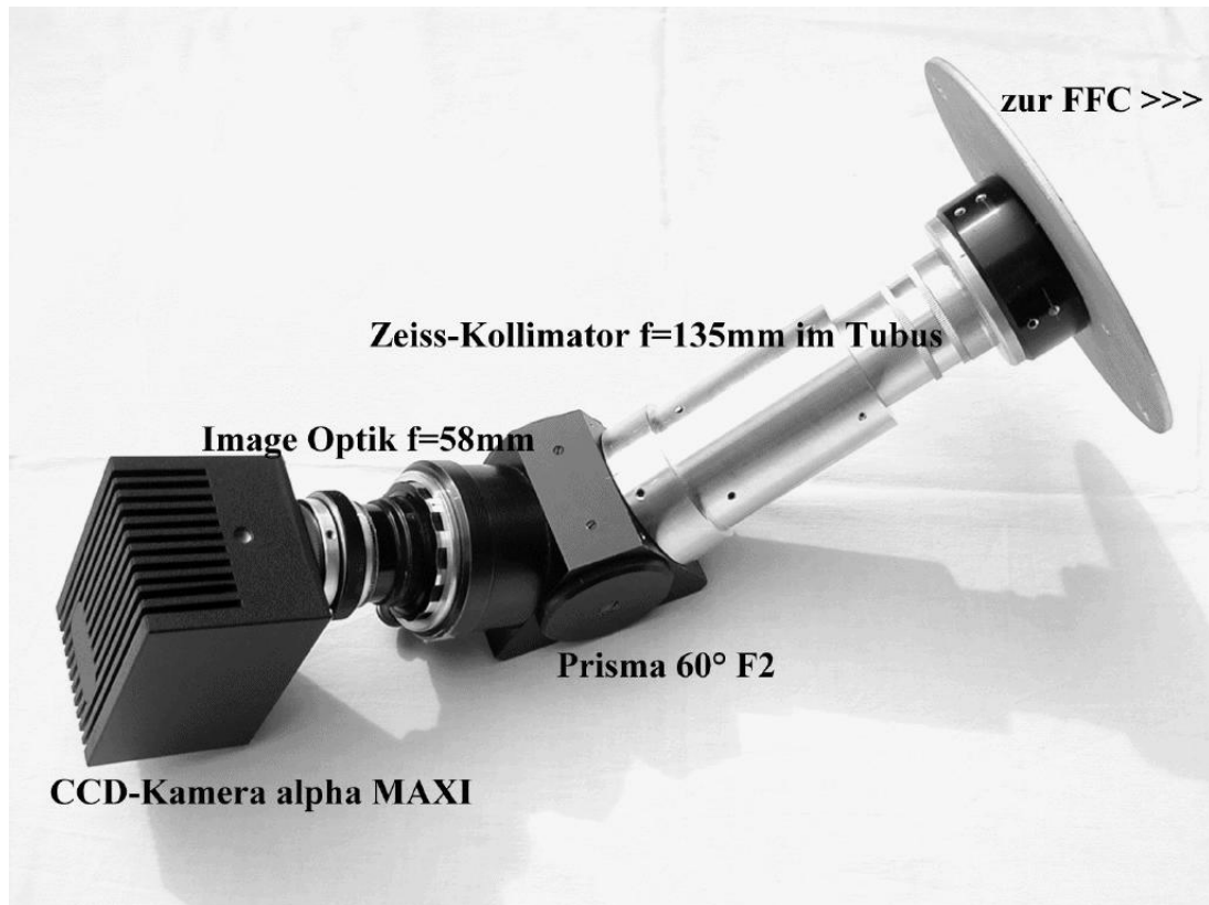
Abbildung 6.9: Spektrographenansatz mit Prisma
