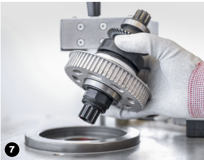
Zwischenprüfung: Im Anschluss an die Tretlagermontage werden Höhe und genauer Sitz der Lager geprüft.
