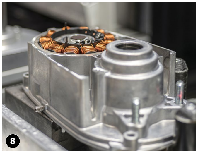
Beginn der Endmontage: Diese startet mit dem Einsetzen und Fixieren des Stators im Motorengehäuse.
