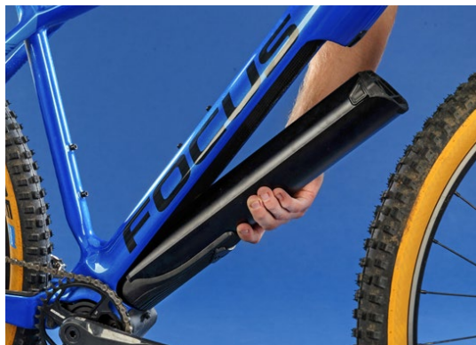
Motor zum Mitnehmen Der Motor kann samt Akku entnommen werden. Eine Abdeckkappe, die stattdessen montiert wird, macht das Bike wieder „vollständig“.
