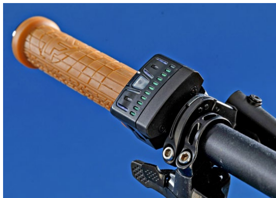
Ein Display sucht man am Fazua-Bike vergebens. Das Bedienteil gibt durch Farbcodes und LEDs Auskunft über Motormodus und Akku-Stand.
