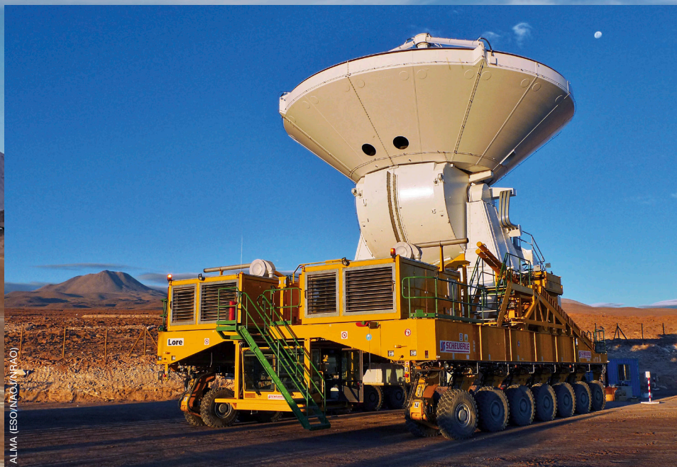
Uma antena ALMA europeia, pesando 100 toneladas, é levada pelo Lore, um dos transportadores gigantes do ALMA, no Centro de Apoio às Operações nos Andes chilenos.
