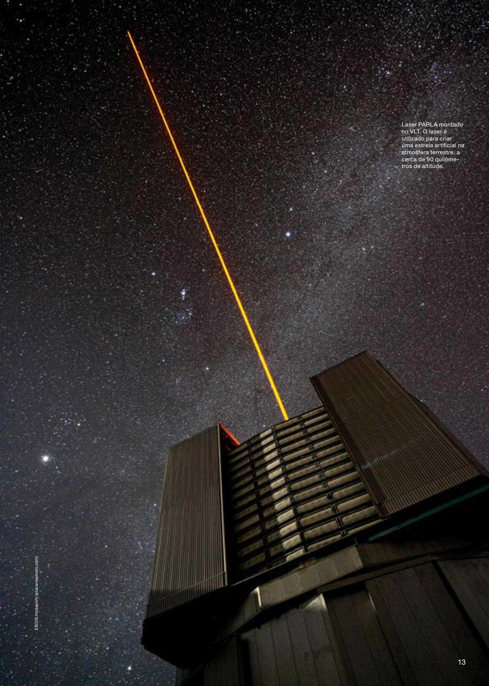
Laser PARLA montado no VLT. O laser é utilizado para criar uma estrela artificial na atmosfera terrestre, a cerca de 90 quilômetros de altitude.
