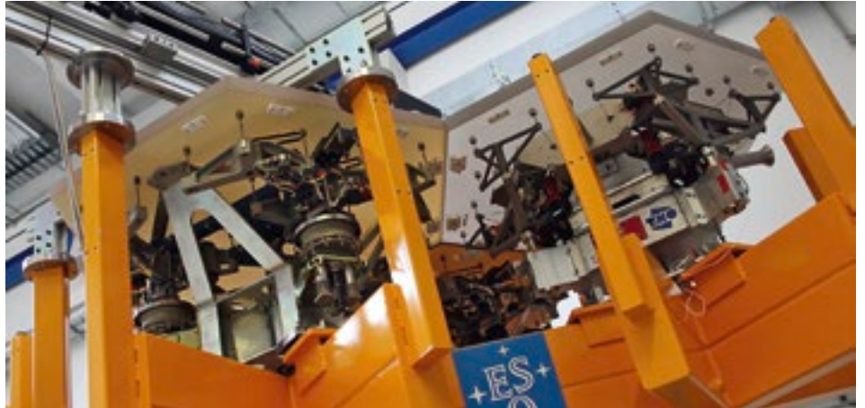
Esta fotografía tomada en ESO, muestra dos segmentos de prueba para el espejo primario de 39 metros del European Extremely Large Telescope. El prototipo del sistema de soporte para el segmento de la izquierda fue elaborado por CESA (España), y el de la derecha por VDL/TNO (Holanda).
